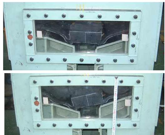
図7 追従状況（上；軸方向変位 下；せん断変位） 写真2 追従状況（上；軸方向変位 下；せん断変位）
