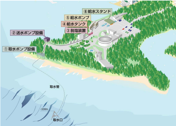
図－1 取水管敷設状況図
