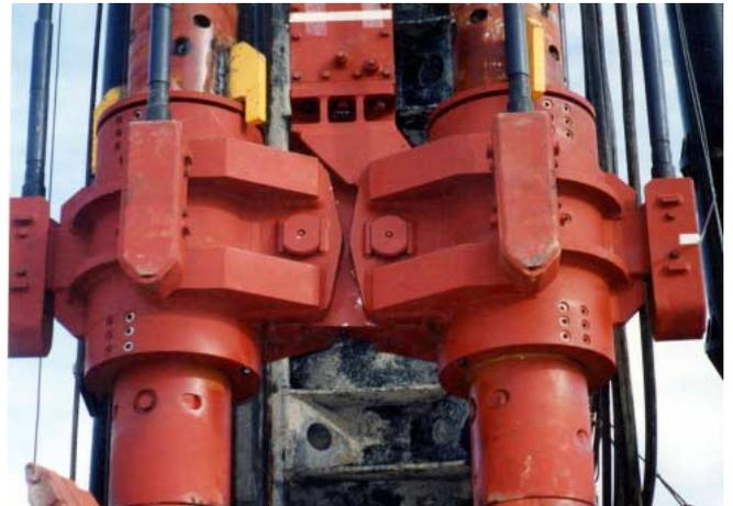
写真-1 ピン式ベアリング連結軸受け
