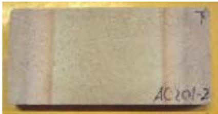
写真-1 アルミナセメント系（配合 c）耐火試験後
