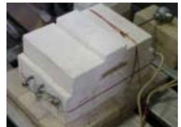
写真-3 耐火・断熱性試験状況
