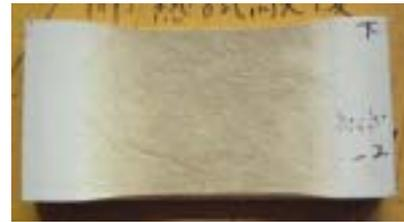
写真-2 ケイ酸カルシウム系（配合 b）耐火試験後
