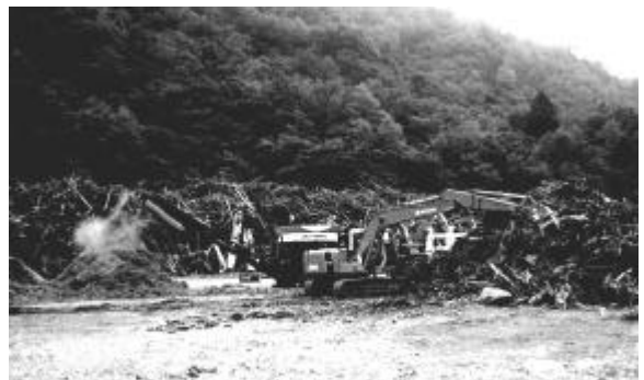
写真—1 破碎機械（タブグラインダー）
