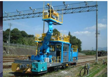
写真-2 トンネル検査車
