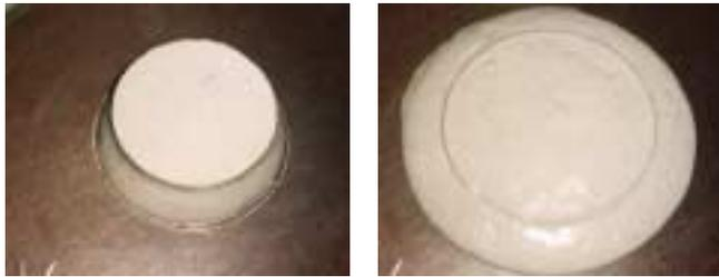
フローコーン引抜き後（自立状態）      15回振動後（流動状態）
