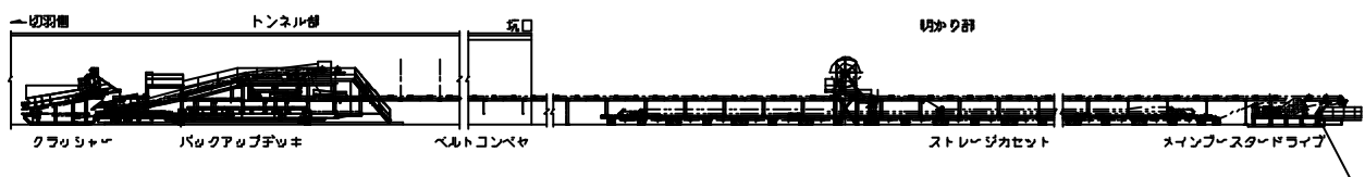
図-2 連続ベルトコンベヤ全体図
