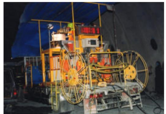
写真 - 5 装填装置本体と装填ホースリール（両側）
