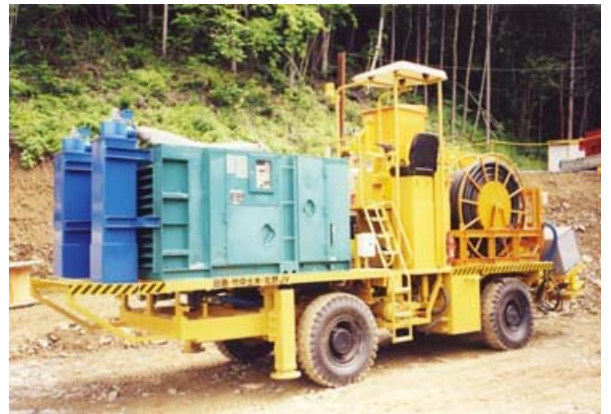
写真—2 吹付け後続台車
