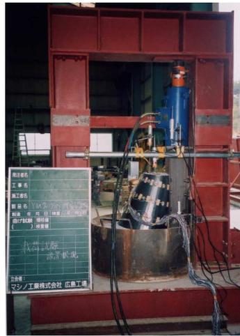
写真-3 YMウイングパイプ载荷状況
