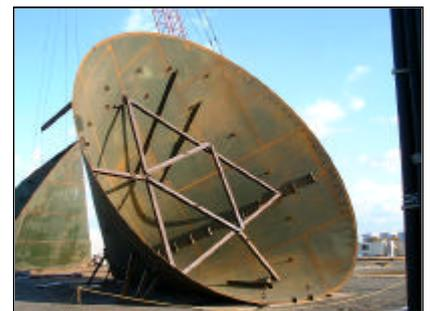
写真 - 1 曲げ加工状況
