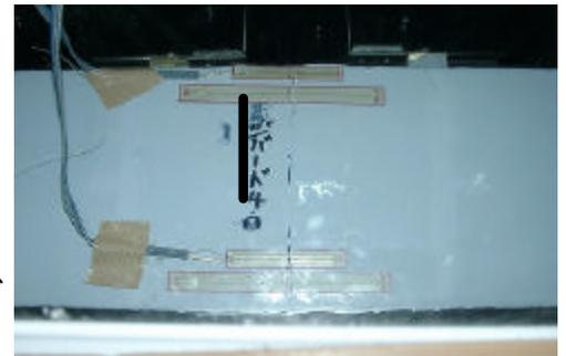
写真-2 試験材料 A 1,000万回時状態
