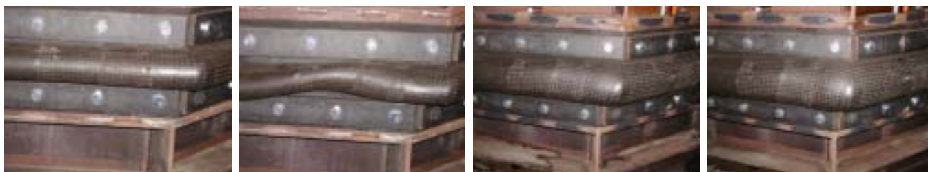
水圧なし ねじれ角0° 水圧なし ねじれ角5.2° 水圧100kN/m²ねじれ角4.0° 水圧180kN/m²ねじれ角3.0°
