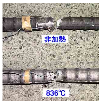
写真-2 破断面の状況
