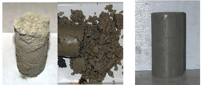
写真-2 従来型裏込注入材の凍結状況（左）と融解時の分解状況（右）
