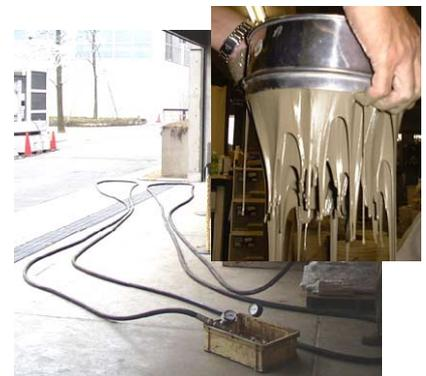
写真-1 凍結地盤用裏込注入材の混練状態（右上）と圧送実験状況
