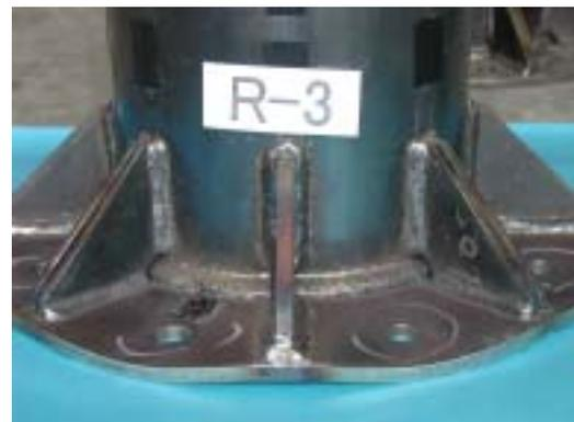
図6 ベースプレート変形の様子
