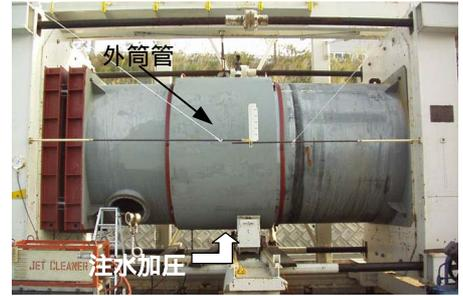
写真-4 外圧負荷試験状況
