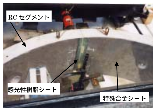
写真-1 特殊合金シート内面被覆セグメント （継手曲げ試験）
