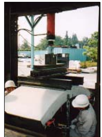
写真-2 単体曲げ試験状況
