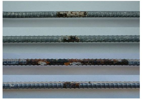
写真-1 鉄筋の腐食状況 (乾湿繰返し 34 週).
