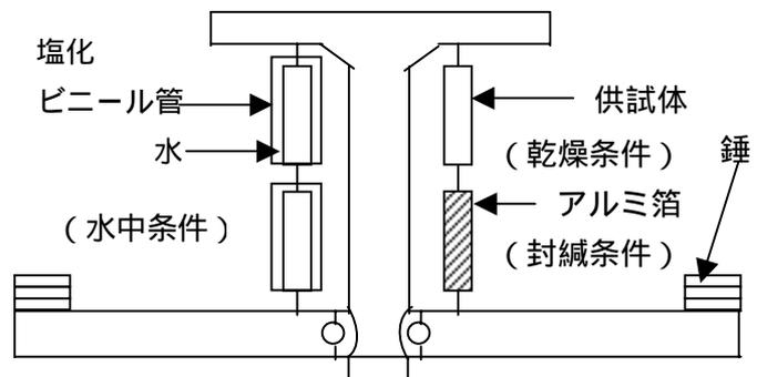
図2 引張クリープ試験装置
