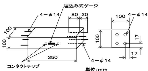
図1 引張クリープ試験供試体
