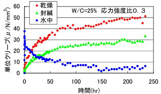
図4 引張クリープ試験結果
