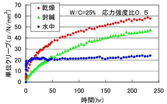
図3 引張クリープ試験結果
