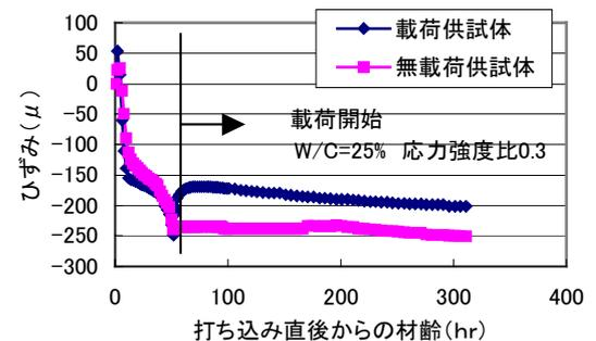
図5 打込み後からのひずみ変化(水中条件)
