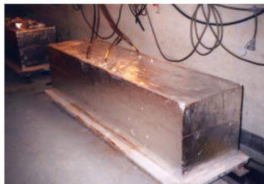
写真 - 1 大型自己収縮試験体の全景
