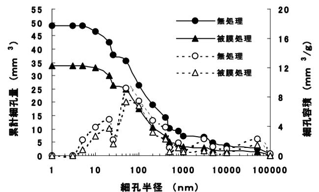
図6 細孔分布の測定結果 (W/C60% Air5%)
