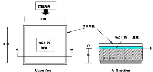
図2 供試体概要図
