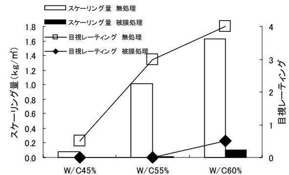
図5 スケーリング量と水セメント比の関係 (Air5%)
