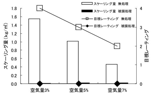
図4 スケーリング量と空気量の関係 (W/C55%)
