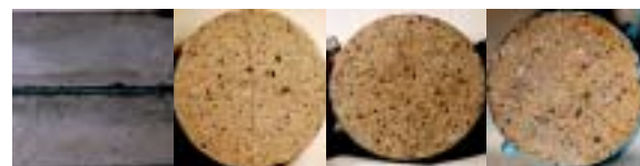
S1 試験 想定 5 年 R1 試験 想定 7 年 R2 試験 想定 10 年 R3 試験 想定 5 年 写真-1 酸性雨による表面劣化性状
