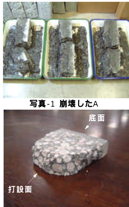
写真-2 崩壊したCの断面
