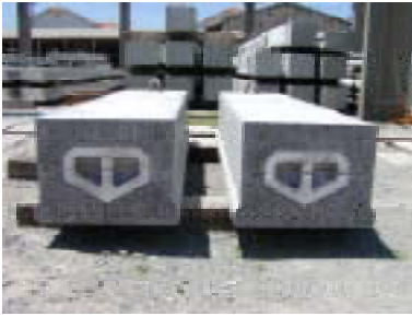
写真-1 主桁切断断面
