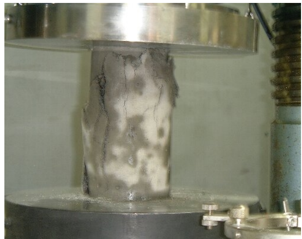
写真-1 ポリプロピレン短繊維を混入したコンクリートの圧縮破壊状況
