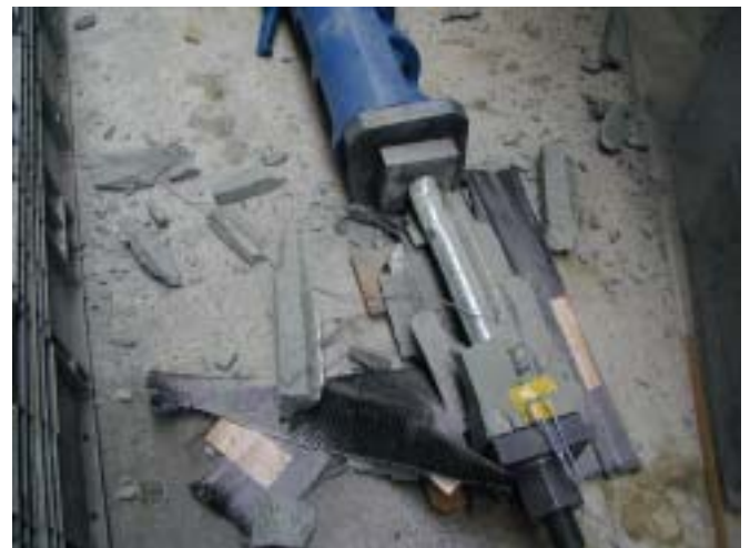
写真-1 圧縮破壊の様子(No.9)
