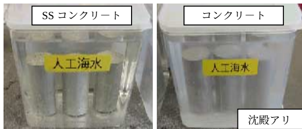
写真-1 人工海水浸漬状況(12ヶ月)
