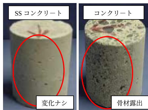
写真-3 湿式摩耗後の外観変化（100時間）
