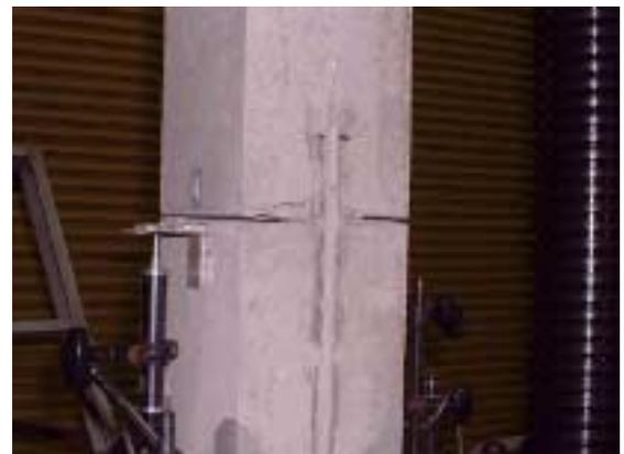
図5 破壊状況 (C試験体)
