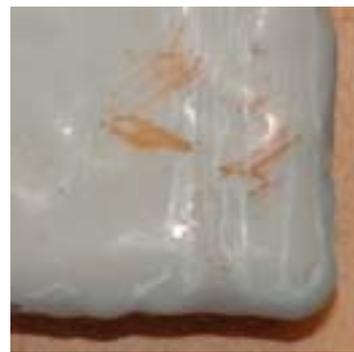
図-2 ウレアウレタン U+S 試験 6SET 後 外観
