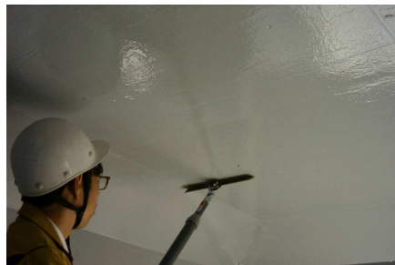
写真-2 ピンホール試験実施状況
