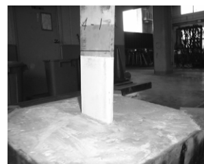
写真-3 試験後試験片状況
