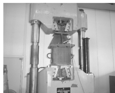
写真-2 付着試験
