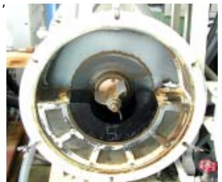
写真-1 掃流式摩耗試験機
