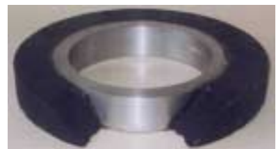
写真-2 打替え工法の試験体
