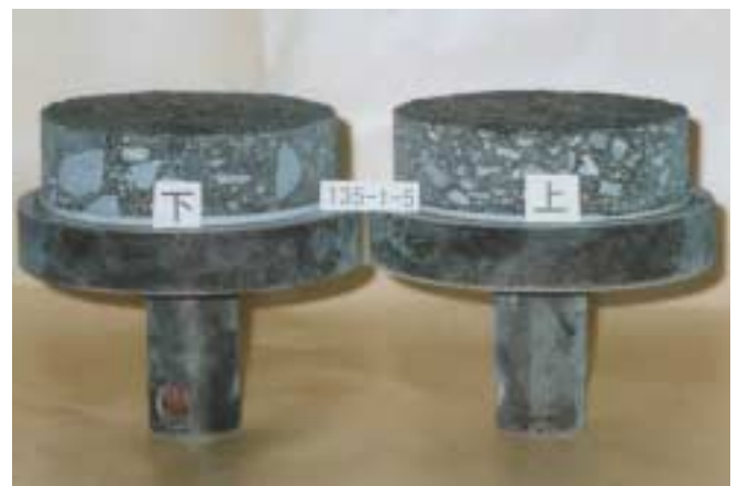
写真-2 引張試験の剥離状況
