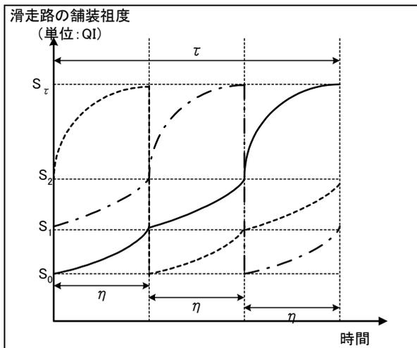
図-1 定常状態における舗装状態と補修方法の関係 (n=3)
