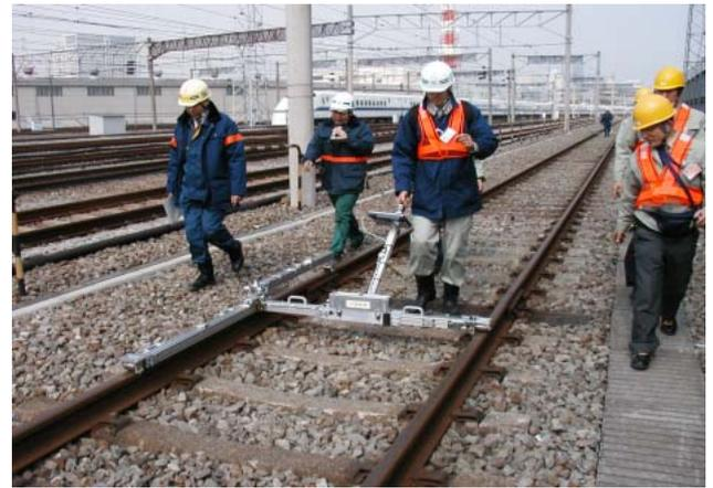
図2 試作した軌道検測装置
