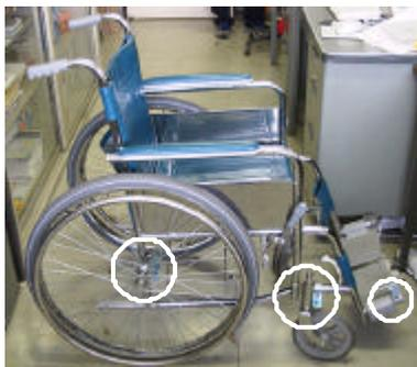
Fig.1 加速度計設置箇所
