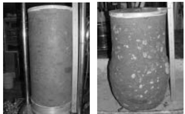
写真-3 試料状況 (No. 1、 $\rho_d=1.910\text{g/cm}^3$ )
