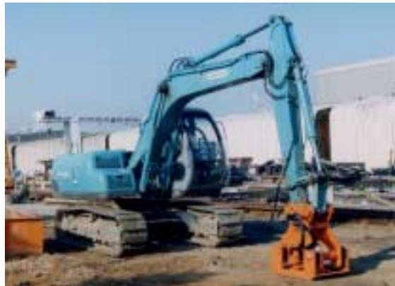
写真-1 バックホウに装着した振動コンパクタ
