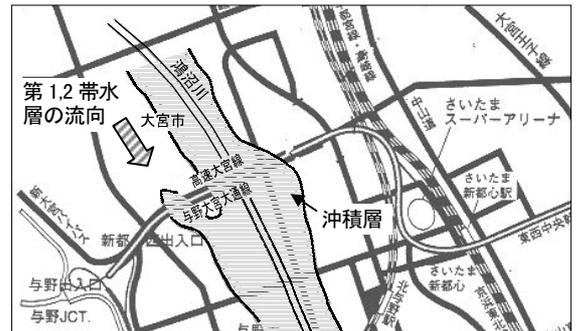
図-2 第1,2帯水層の流向および軟弱層の分布範囲
