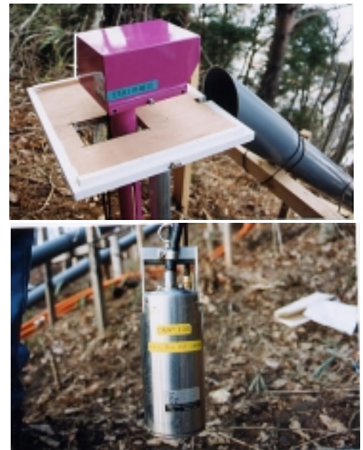
図 1 (上)FBG 伸縮計,(下)FBG 水位計
