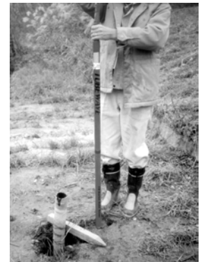
図1 ボアホールアンテナ外観
