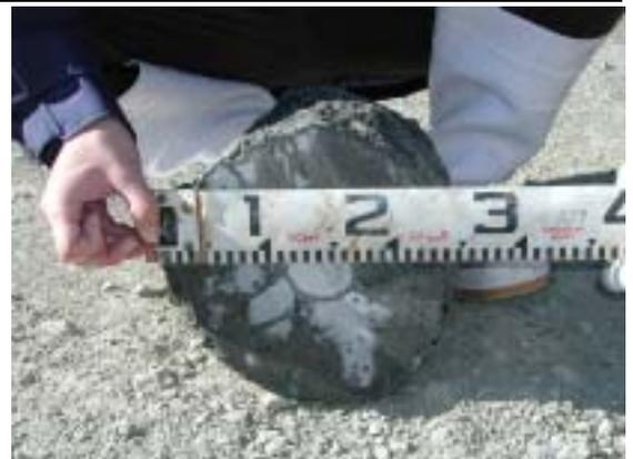
写真-1 杭先端定着部の断面
