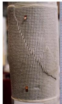
図 - 3 供試体の破壊性状
