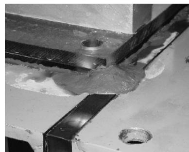
図8 模型端部より発生した路盤噴泥
