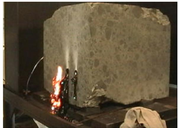
図-5 レーザ照射直後の状況
