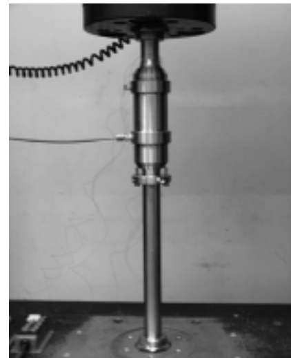
図 1 封圧下の引張試験の様子
